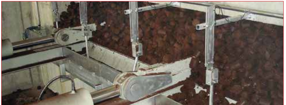
Robuster hydraulischer Schubboden zum Austrag von Biomasse mit hoher Schüttdichte
